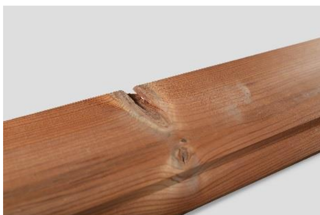
Duże pęknięcie sęka.
